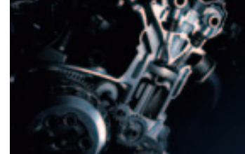
Motor de 4 tiempos DOHC de 999 cc.
